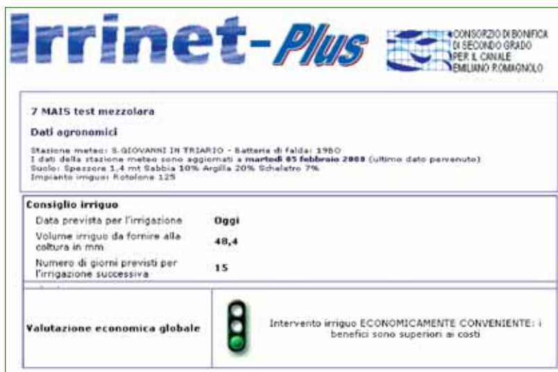
Fig. 1 - Esempio di consiglio irriguo di Irrinet-Plus, con indicazione del momento di intervento irriguo, del volume d'adacquata e del sicuro vantaggio economico dell'irrigazione. (Fonte: Cer)
